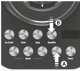
8. **Boost (Anlık Çalıştırma) Fonksiyonu:** Cihazı kısa süreliğine hızlı bir şekilde çalıştırmamız gerekiyorsa blenderi "Boost" düğmesini (A) basılı tutarak çalıştırın. **Smoothie Fonksiyonu:** Özel program sayesinde buz kırma ve smoothie'nizi istediğiniz yoğunlukta karıştırmak için "Smoothie" düğmesine (B) bir kez basın. Program hazır olduğunda blender otomatik olarak durur.
